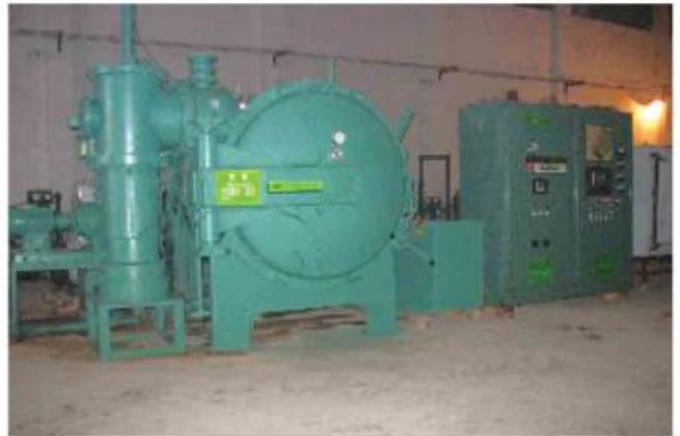
Vacuum sintering furnace-진공 소결로
